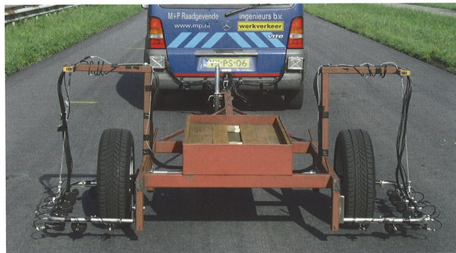
Speciaal ontworpen aanhanger om het geluid dicht bij de band te meten. Aan elke zijde zijn elf microfoons bevestigd om het geluid rondom de gehele band te meten.
