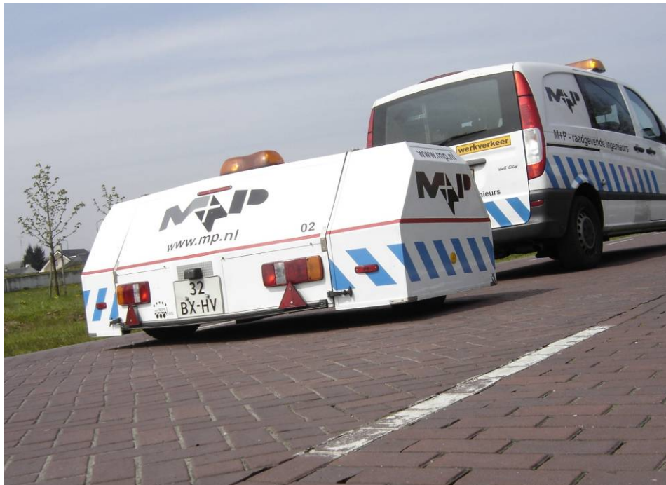
CPX-meting aan een verharding met straatbakstenen
