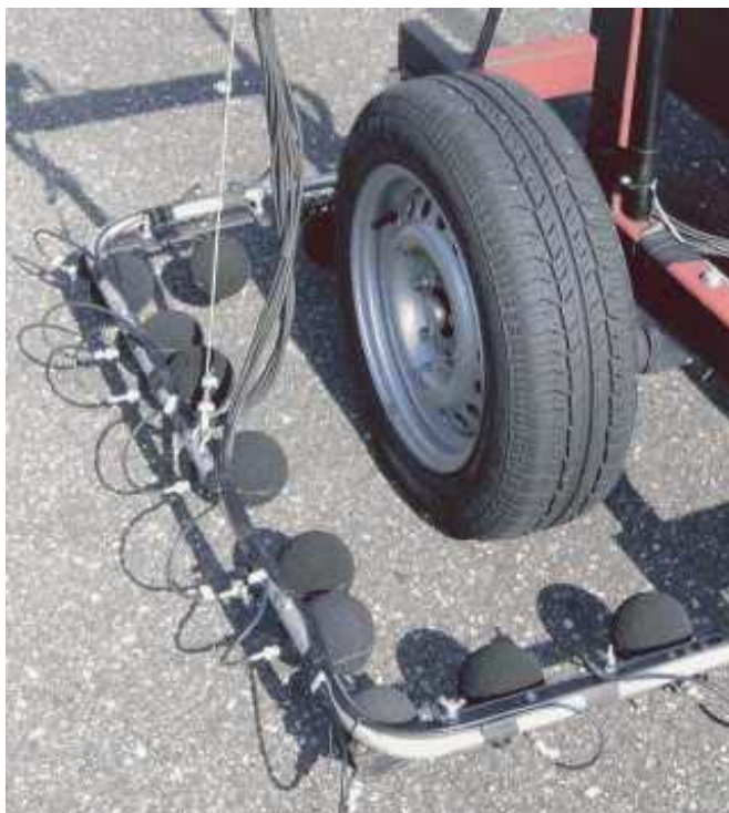
Detail van de geluidmeettrailer voor testterreinen
