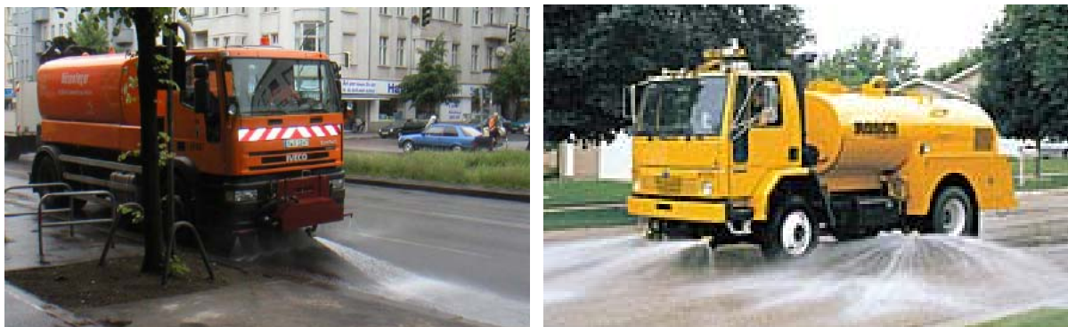
Figuur 5: Voorbeelden van voertuigen die ingezet worden in Duitsland (links) en Canada (rechts) voor het nat sproeien van het wegdek om de fijn stof concentratie te verlagen
