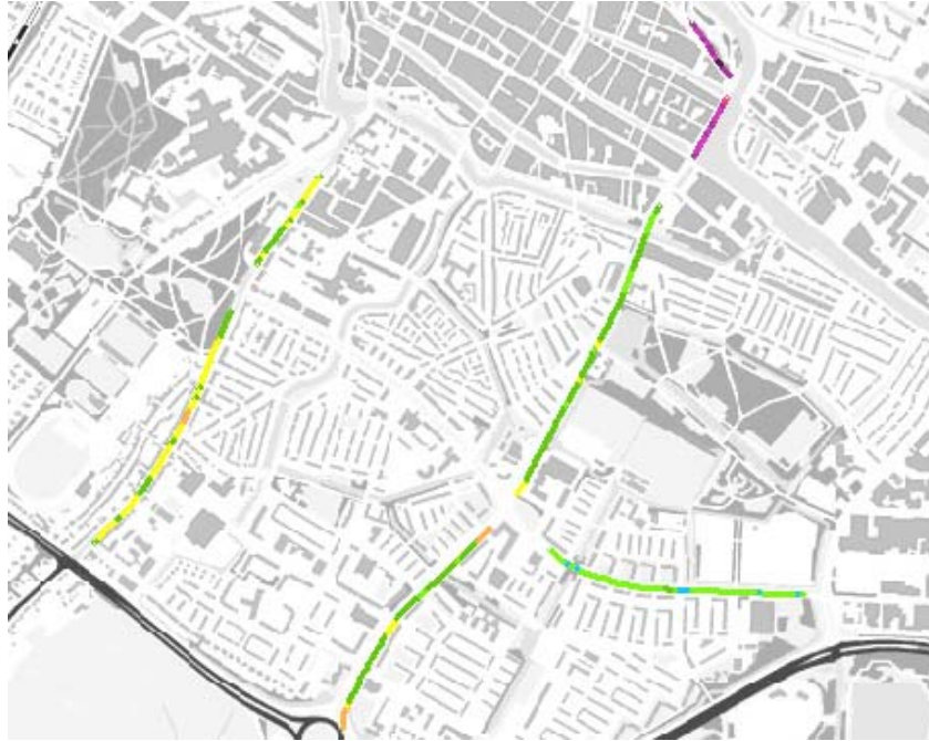
Figuur5 : Detail uit de GeoCPX-kaart Alkmaar (geluidniveaus in kleur weergegeven!)
