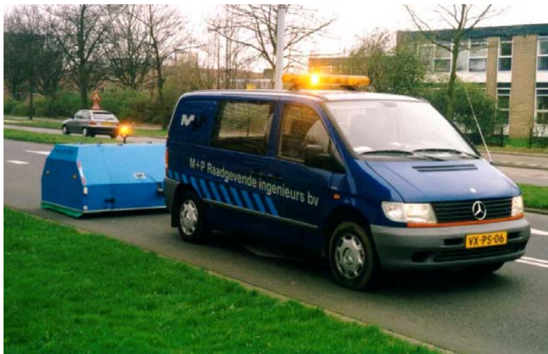
Figuur 1: CPX-meting in uitvoering
