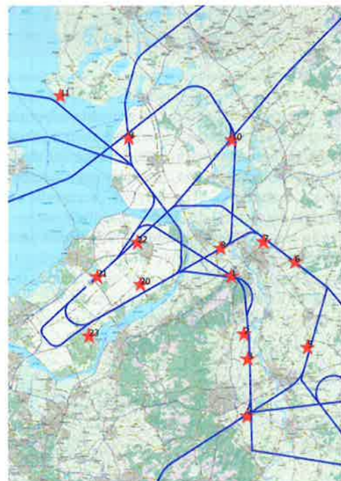
FIGUUR 1: ROUTE VAN DE BELEVINGSVLUCHT EN POSITIE VAN DE GELUIDMEETPUNTEN (BIJ BENADERING) BRON: WWW.BELEVINGSVLUCHT.NL/BELEVINGSVLUCHT-LELYSTAD-AIRPORT/GELUIDSMETINGEN-EN-BELEVING
