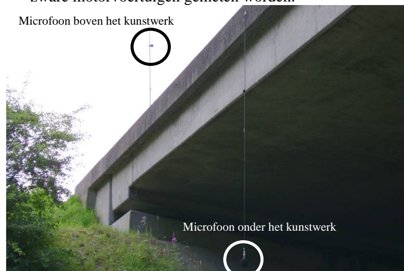
Figuur 4 Microfoonpositie aan de boven- en onderzijde van het kunstwerk
