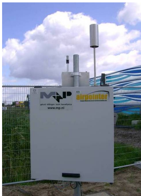
Figuur 6 NOX meetapparatuur
