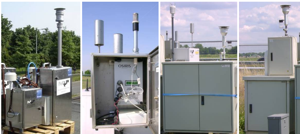
Figuur 5 Fijn stof meetapparatuur, van links naar rechts LVS, Osiris, TEOM en TEOM-FDMS
