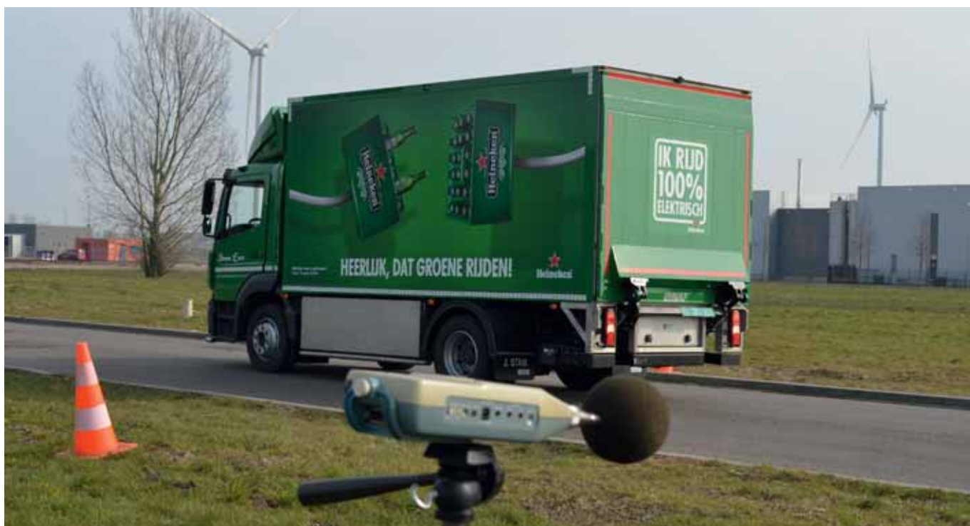
FIGUUR 1: VOORBEELD VAN EEN VOLLEDIG ELEKTRISCHE VRACHTWAGEN (CA. 15 DB STILLER DAN EEN STANDAARD VRACHTWAGEN ONDER VERGELIJKBARE RIJOMSTANDIGHEDEN)
