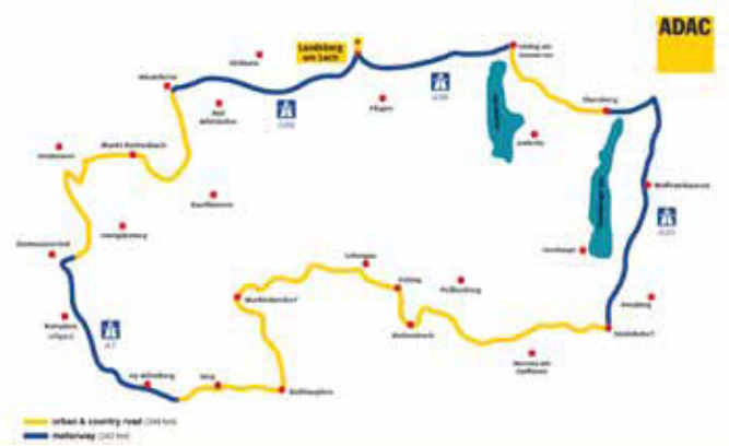
Figuur 5. Metingen bandenslijtage met de 'konvooi'-methode: vier voertuigen rijden meermaals dezelfde meefronde (bron: ADAC)
