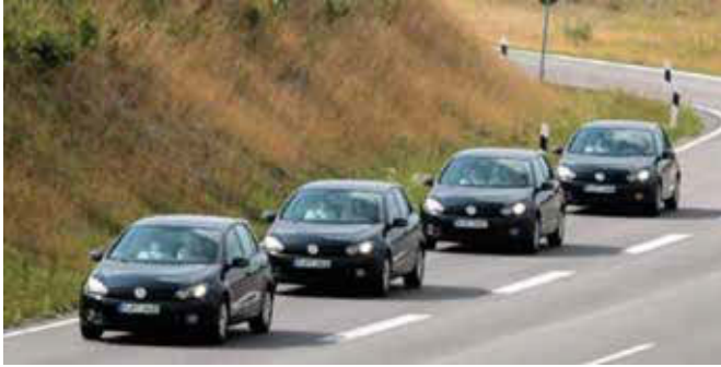
Figuur 5. Metingen bandenslijtage met de 'konvooi'-methode: vier voertuigen rijden meermaals dezelfde meefronde (bron: ADAC)
