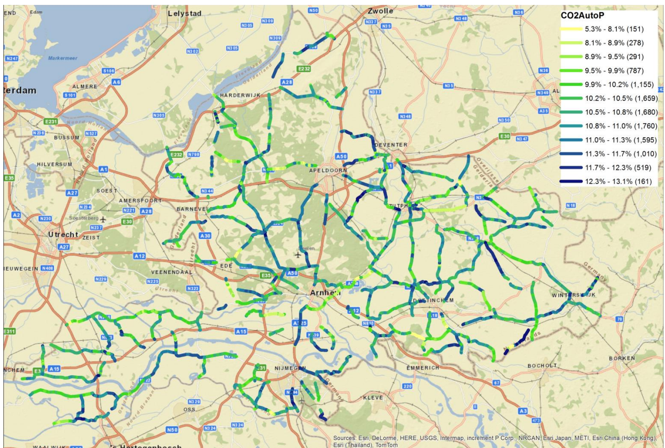
figuur 26 CO 2 -uitstoot in 2022 op basis van een autonome groei van 1,0% per jaar. Op de kaart is de verandering van de CO 2 -uitstoot ten opzichte van de referentie situatie weergegeven. Een positief percentage geeft aan dat de uitstoot in dit scenario is toegenomen ten opzichte van de referentie situatie.
