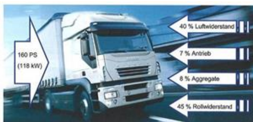
figuur 16 Aandeel van verschillende wrijvingskrachten in het totale brandstofverbruik van een vrachtwagen bij 85 km/h [5]
