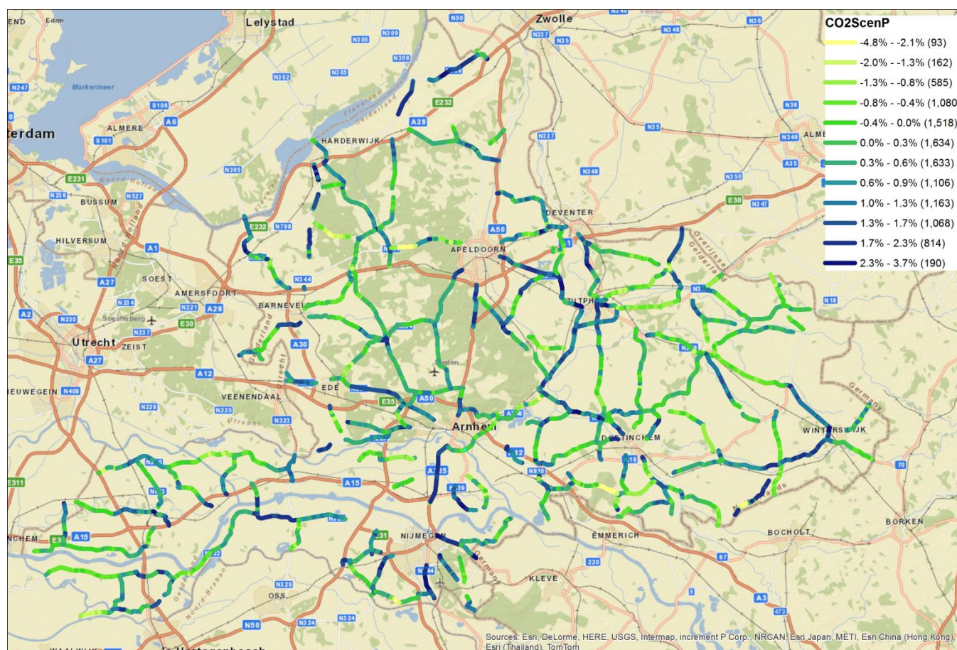
figuur 21 Scenario 2: 40 % SMA 11 en 60 % DAB 16 ( RRC_{SMA11} = 9,15 \text{ kg/t} en RRC_{DAB16} = 8,77 \text{ kg/t} ). Op de kaart is de verandering van de CO 2 -uitstoot ten opzichte van de referentie situatie weergegeven. Een positief percentage geeft aan dat de uitstoot in dit scenario is toegenomen ten opzichte van de referentie situatie. Een negatief percentage geeft aan dat de uitstoot in dit scenario is afgenomen ten opzichte van de referentie situatie.
