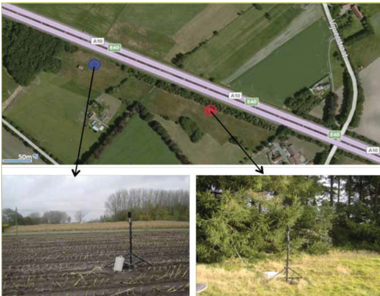
Figuur 1: Voorbeeld van de gebruikte meetopstelling in Beernem: referentiemeting (links onder) en meting achter de vegetatie (rechts onder) naast de E40.
