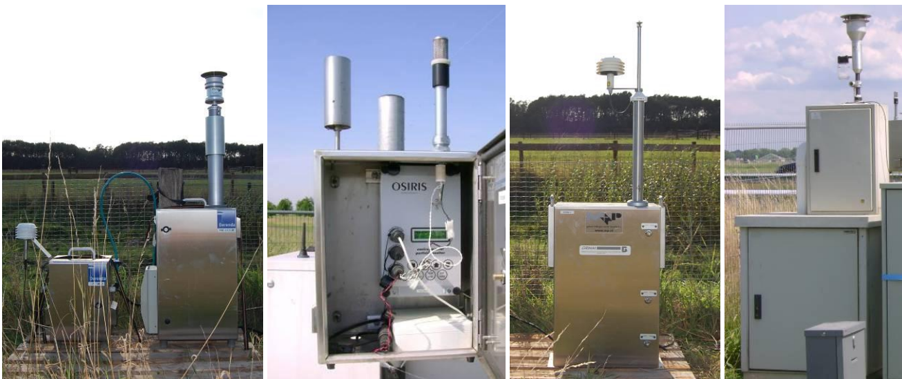
figuur 1 Fijn stof meetapparatuur, van links naar rechts LVS, Osiris, GRIMM en TEOM-FDMS
