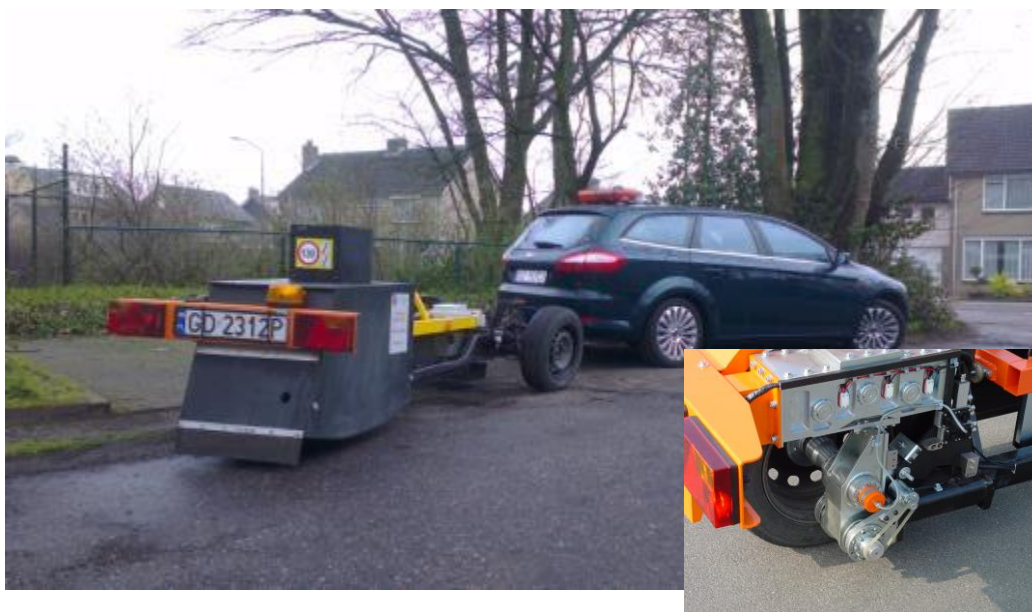
figuur 2 De TU Gdansk trailer voor het uitvoeren van rolweerstandmetingen. De gedetailleerde foto laat de bevestiging van de meetband zien
