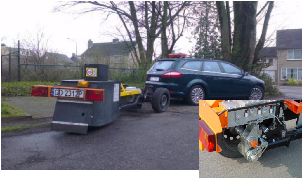
figuur 2 De TU Gdansk trailer voor het uitvoeren van rolweerstandmetingen. De gedetailleerde foto laat de bevestiging van de meetband zien
