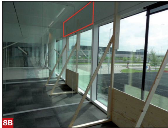
8B Metingen varianten ruimteakoestiek in mock-up, variant koofabsorptie (The Outlook)
